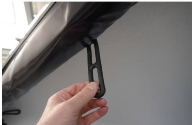
Abb. 8: Gummizug des Planenlifts greifen
