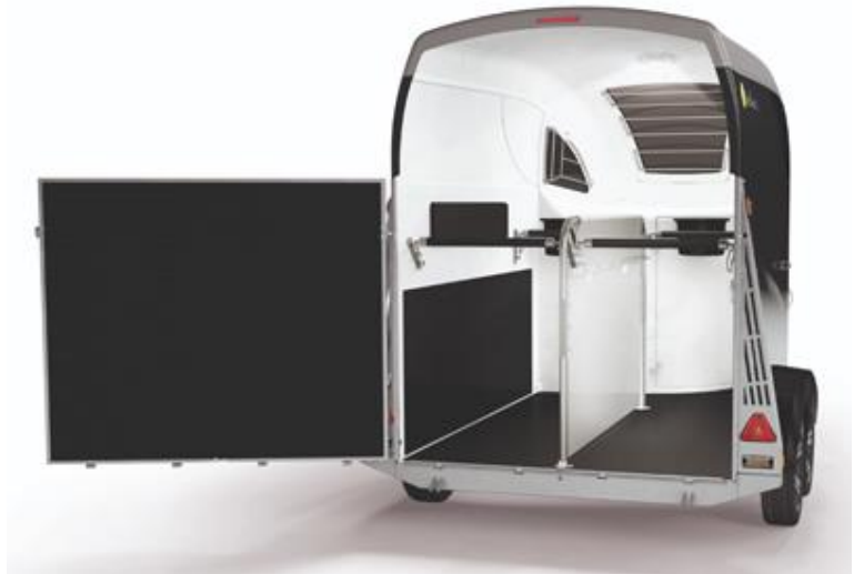
Abb. 12: Rampe-Tür-System 180° Schwenkbar nur nach links
